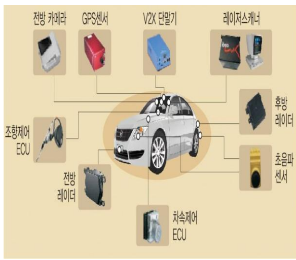
[그림 6] 자율주행 시스템 구성
